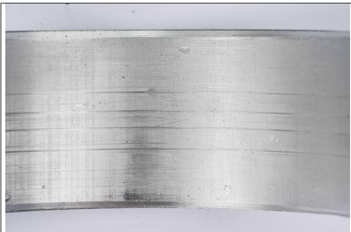
Рис. 46. Вкладыш подшипника коленчатого вала с искусственными повреждениями
