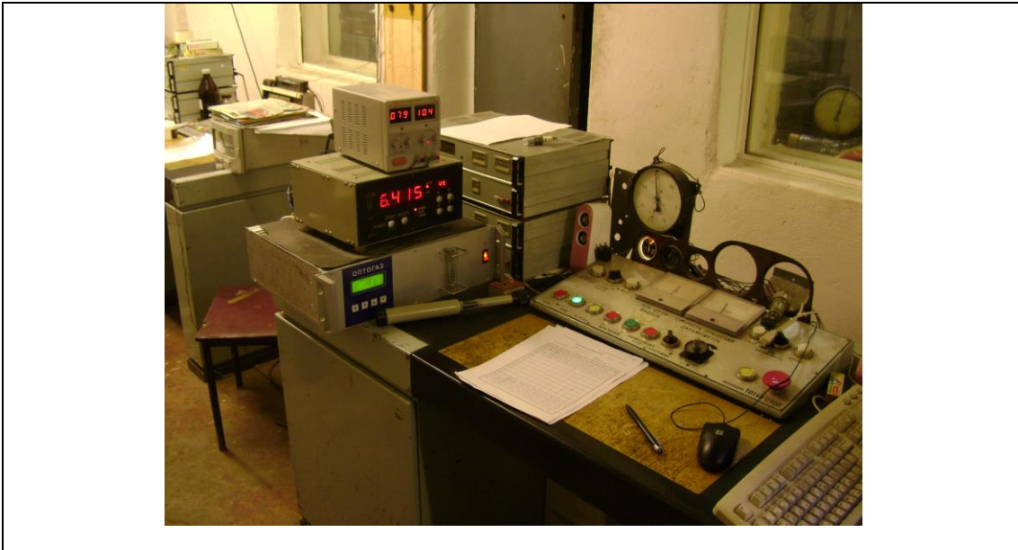
Рис. 3. Пульт управления стандом. Расходомер топлива и газоанализатор.
